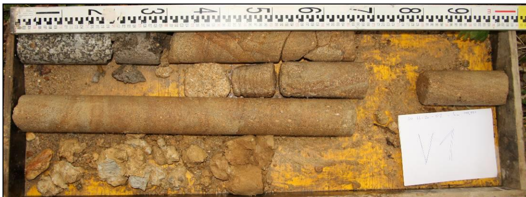
Obr. č. 1 - diagnostický vrt V1 - opěra Plzeň
