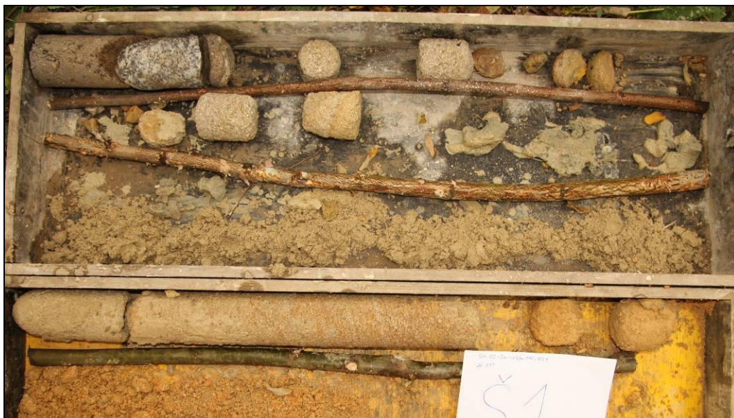
Obr. č. 2 - diagnostický vrt Š1 - opěra Plzeň
